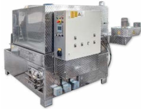
Toploader pour le décapage de peinture par aspersion
