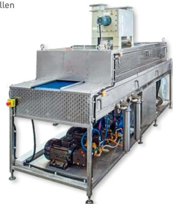
Durchlauf-Reinigungsanlage zur Entschichtung von Folien
