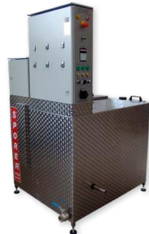
Abb. Anlage zur Innenreinigung von Rohren
