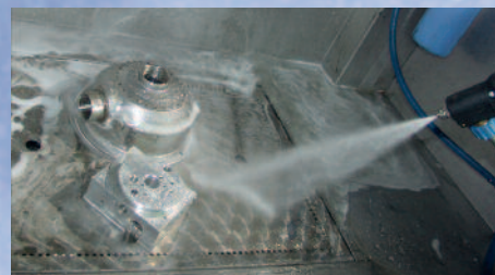
Reinigung über Hochdruckpistole
