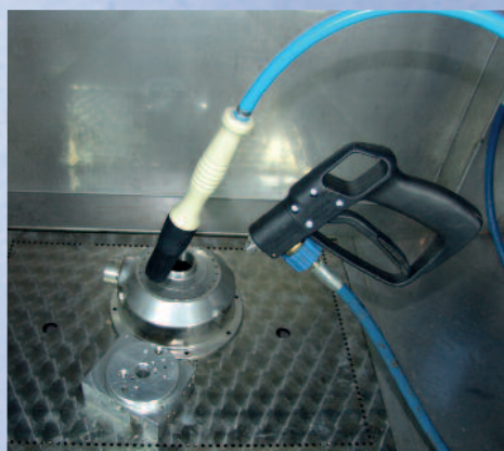
Reinigungsmöglichkeit über HD-Spritzpistole oder Pinsel
