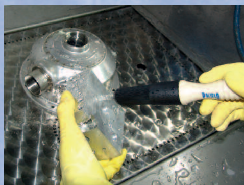
Reinigung über Hohlpinsel bei geöffneter Türe
